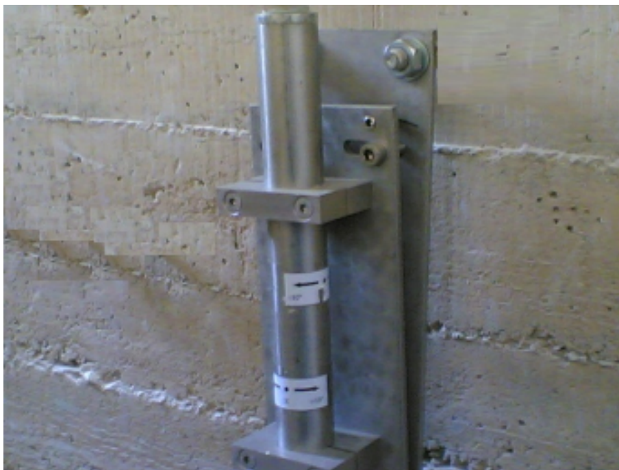
Fig. 3 – Inclinometro da parete installato su una struttura in CLS
