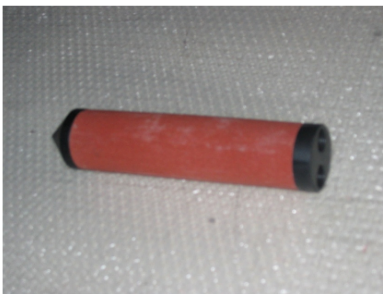
Fig. 2 – Cella piezometrica tipo “Casagrande”
