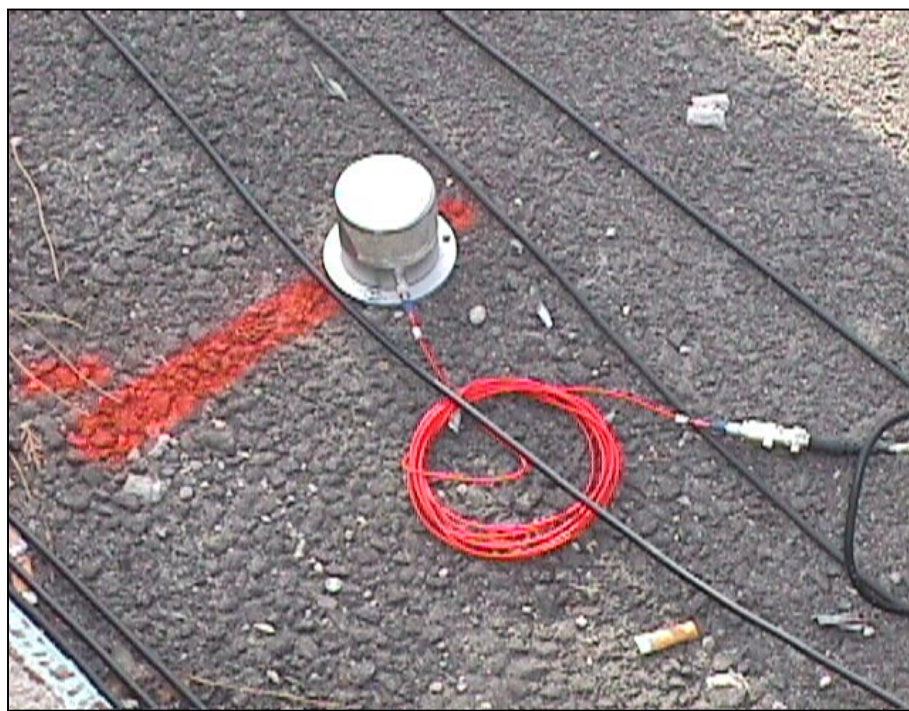
Fig. 5 – Accelerometro triassiale: esempio di applicazione a terra
